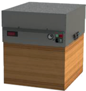
Figure 8. Prototype du dispositif thermique présenté à Avignon, qui selon la température sélectionnée, pourrait être utilisé comme antiparasitaire pour la totalité des abeilles ou seulement des cadres de couvain operculé, cérificateur, séchoir de pollen, liquéfacteur de miels en rayon ou pots et couveuse de reines (US patent application 62/749,704).
